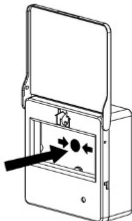
Para accionar el pulsador, es necesario levantar la tapa transparente de protección, y presionar sobre la lámina blanca hasta que enclave, un indicador de color amarillo aparecerá en la parte inferior. El pulsador manual se pondrá en estado de alarma activando el led de color rojo de modo continuo.
